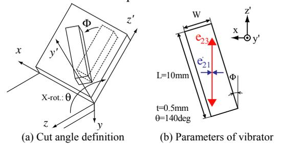
Fig. 9. Design parameter of vibrator.
